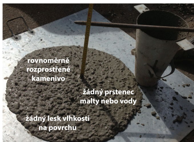
OBRÁZEK A.4: Sednutí betonu o indexu vizuální stability VSI třídy 0 (podle ASTM C1611)
