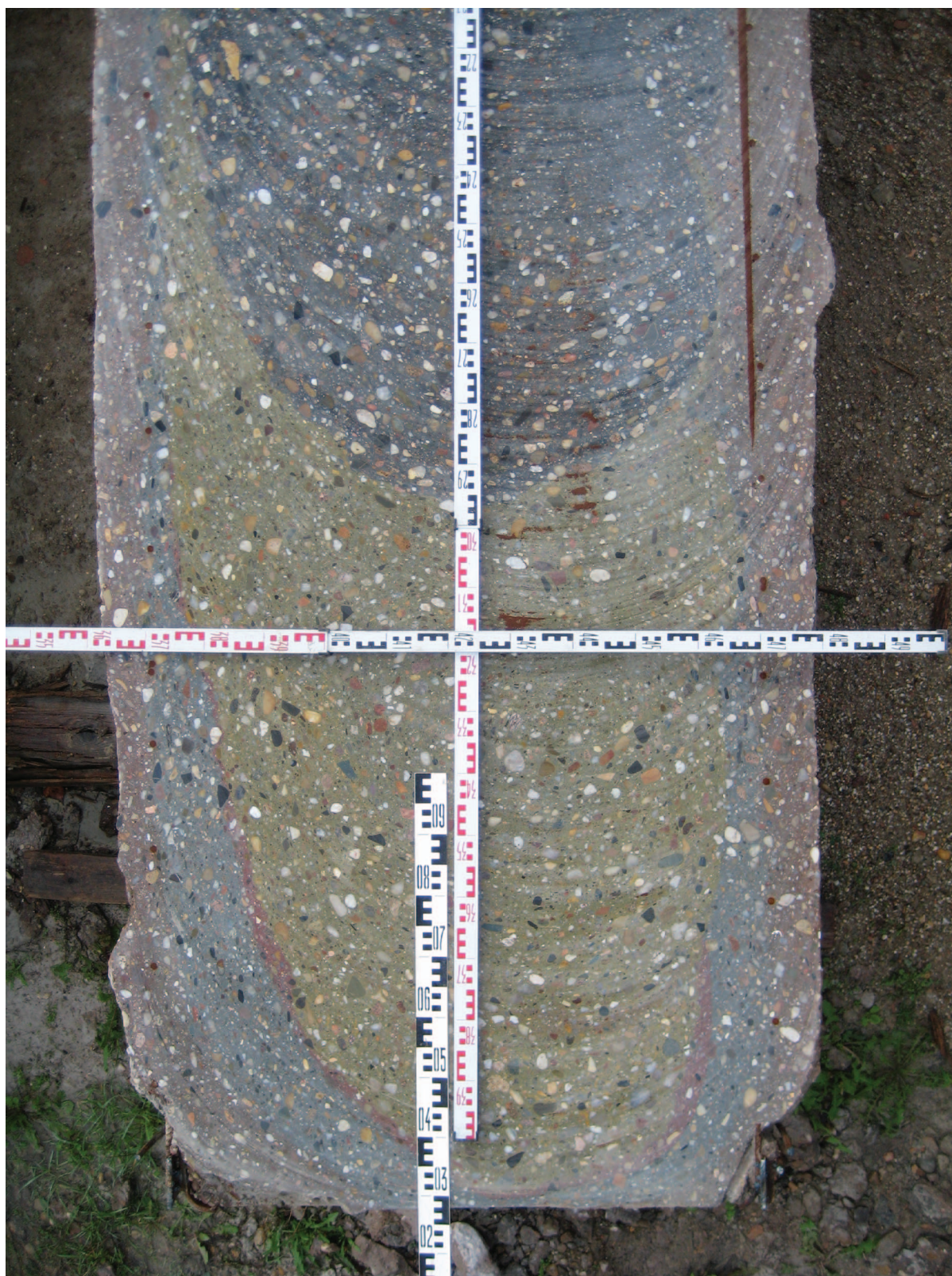
OBRÁZEK 14: Řez vrtanou pilotou betonovanou licí rourou s různě obarvenými dávkami betonu (Böhle, Pulsfort, 2014)
